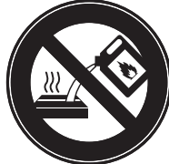
FÜLLEN SIE KEINEN BRENNSTOFF EIN, WENN DAS GERÄT HEISS IST
