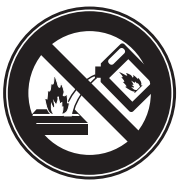
FÜLLEN SIE KEINEN BRENNSTOFF WÄHREND DES BETRIEBS EIN
